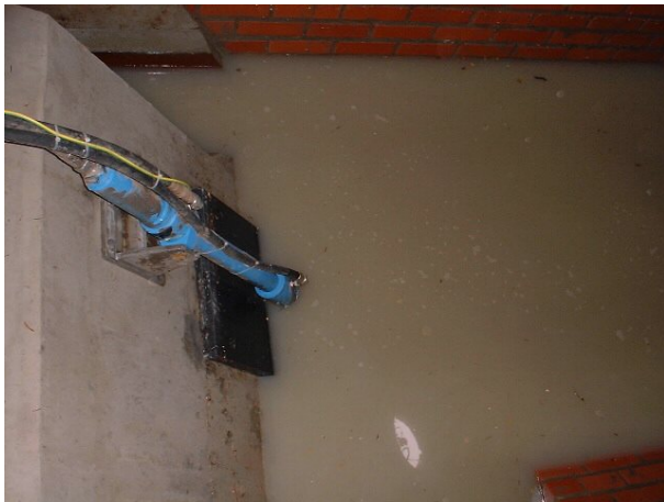
Abbildung 3: Einstau des Spülvolumens
