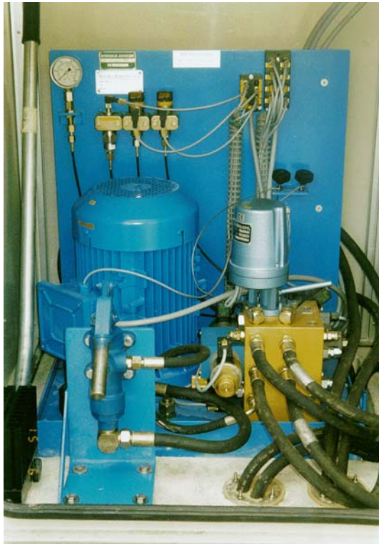
Bild 7: Schaltschrank, Hydraulikaggregat und Hydraulikzylinder
