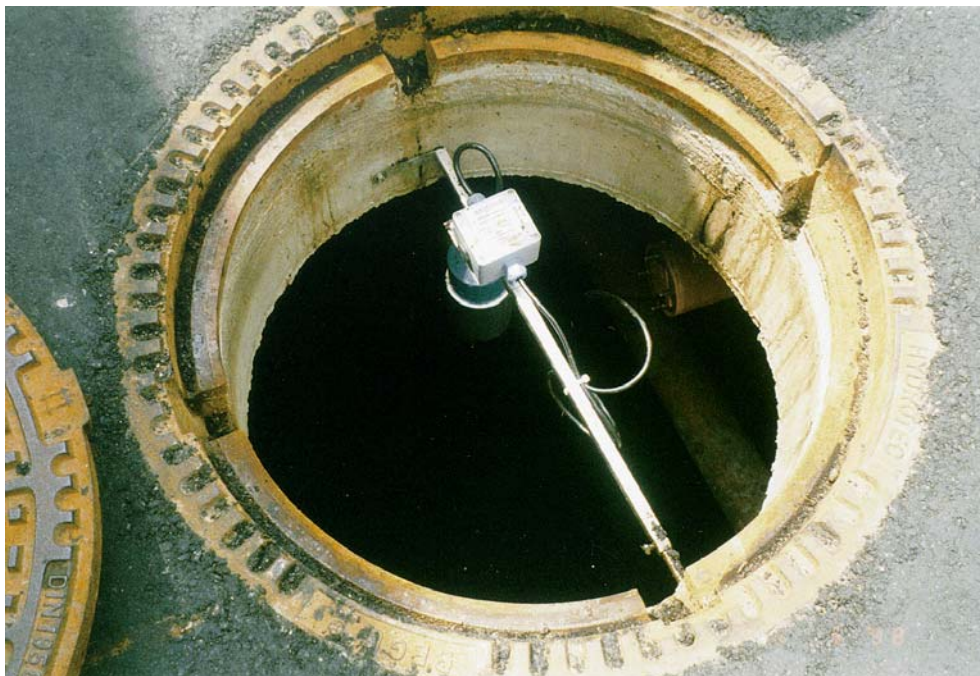
Bild 8: Ultraschallsonde zur Wasserstandsmessung
