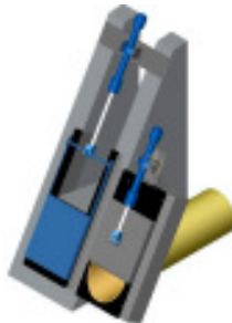
Schwall-Drossel- und Skimmer-Schieber
